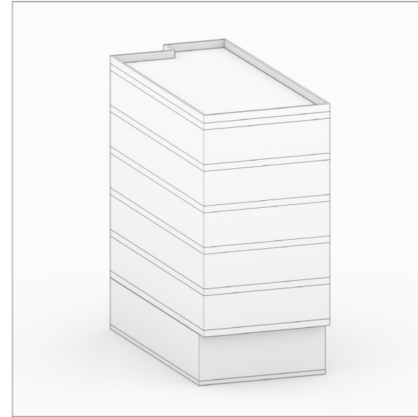
۱- حجم اولیه پروژه بر اساس ۵ طبقه مسکونی به ارتفاع ۳,۶ متر روی طبقه همکف به ارتفاع ۴,۵ متر
