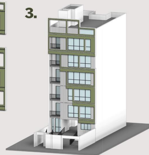
اضافه کردن پوسته‌ی 25 سانتی متری پله‌ای به بخشی از نما همراه با حفظ یکپارچگی پنجره‌های موجود
