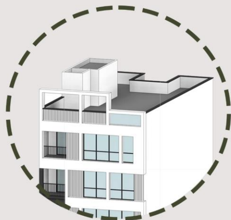
قاب‌سازی نما در بخش بام جهت هم‌راستا سازی ارتفاع ساختمان با ساختمان غربی مجاور پروژه
